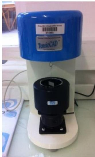
FIGURE 2.36 – Tensiomètre - TensioCad [71]
