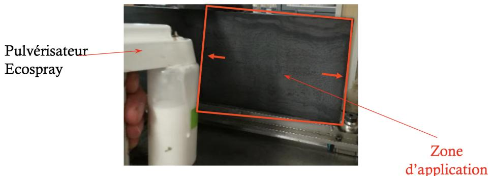
FIGURE 2.48 – Application de l'émulsion sur la plaque
