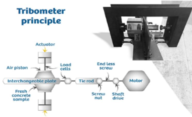
FIGURE 2.46 – Schéma de principe du tribomètre plan/plan [99]
