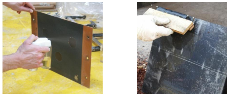
FIGURE 2.59 – Application des huiles (a) Pulvérisation directe, (b) Pulvérisation suivi d'un raclément
