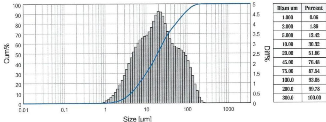
FIGURE 2.72 – Courbe granulométrique laser des cendres volantes de biomasse
