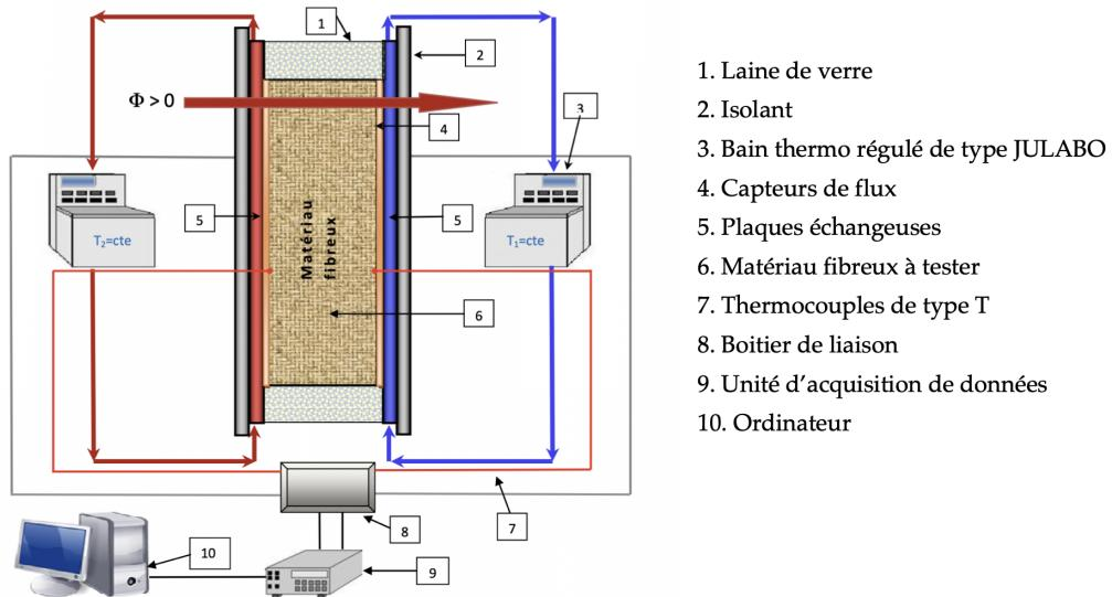
FIGURE 2.30 – Schéma du montage expérimental LGCgE
