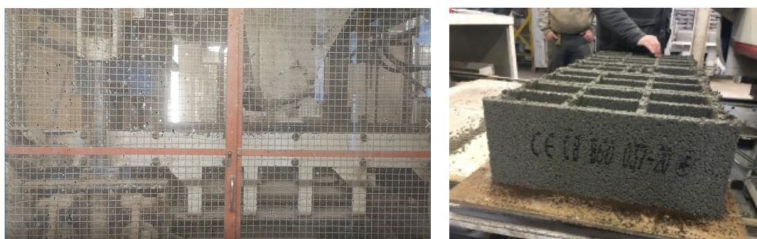
FIGURE 2.79 – Presse vibrante Biallais Ind. (gauche) - Blocs réalisés (droite)
