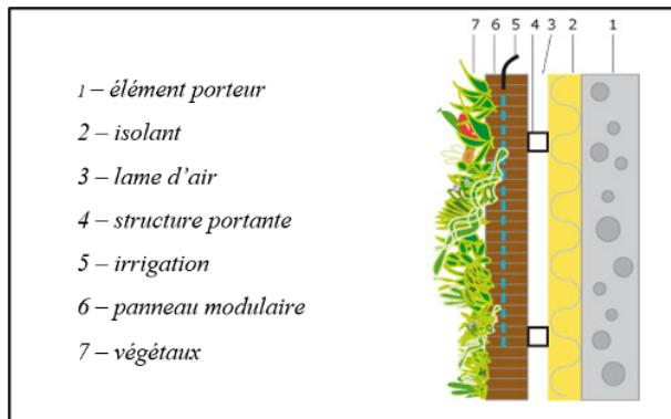
FIGURE 2.6 – Schéma de principe d'un mur complexe
