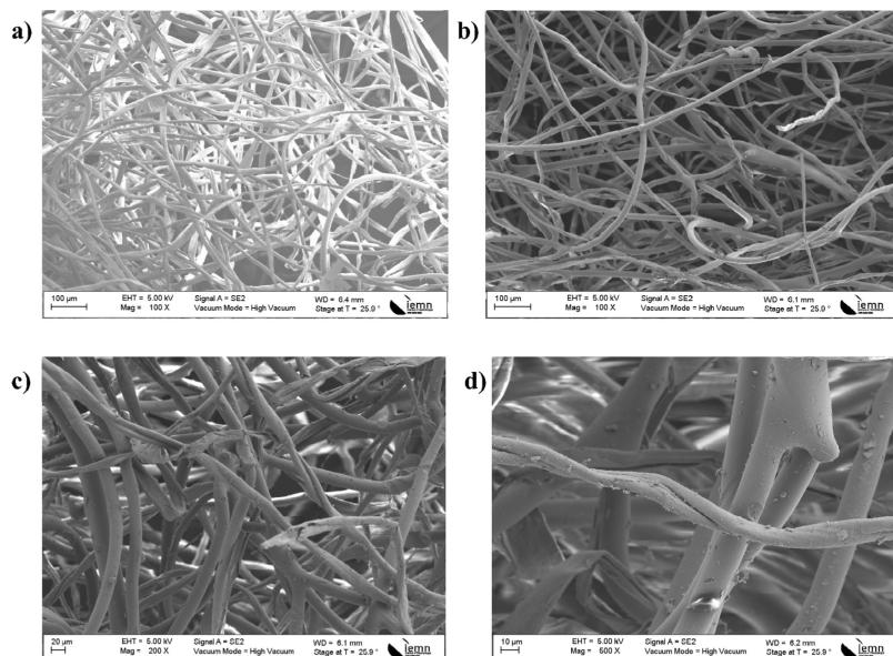
FIGURE 2.31 – Micrographies électroniques à balayage de fibres d'échantillons d'isolants en textile recyclé à des grossissements de 100× (a, b), 200× (c) et 500x (d)[46]
