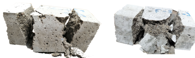
FIGURE 2.76 – Photos de la rupture d'une éprouvette prismatique composée de cendre de biomasse à 10% et 20% (MC10 et MC20)
