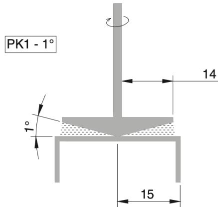
FIGURE 2.33 – Schéma du dispositif cône/plan [68]
