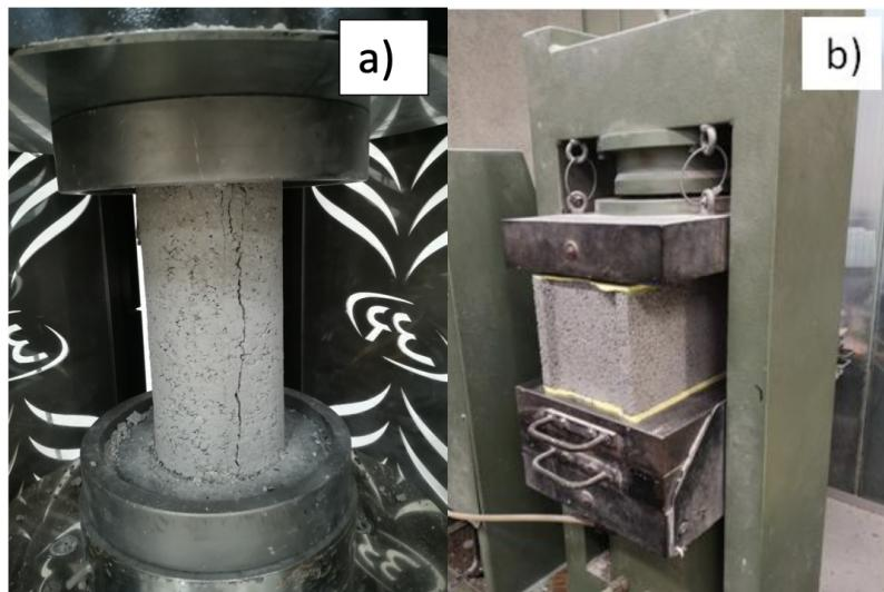
FIGURE 2.80 – Eprouvette cylindrique de laboratoire (a) - Bloc de béton industriel (b)
