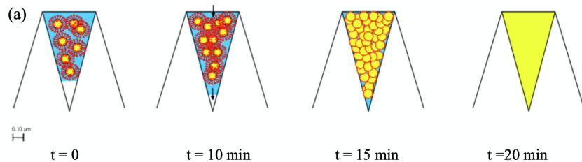
FIGURE 2.39 – Evolution schématique des émulsions directes dans l'état de Wenzel [79]
