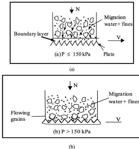
FIGURE 2.47 – Représentation schématique de l'interface béton/coffrage métallique [105]
