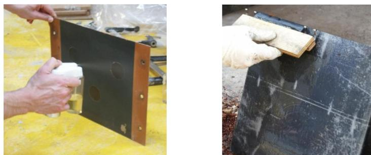
FIGURE 2.59 – Application des huiles (a) Pulvérisation directe, (b) Pulvérisation suivi d'un raclement
