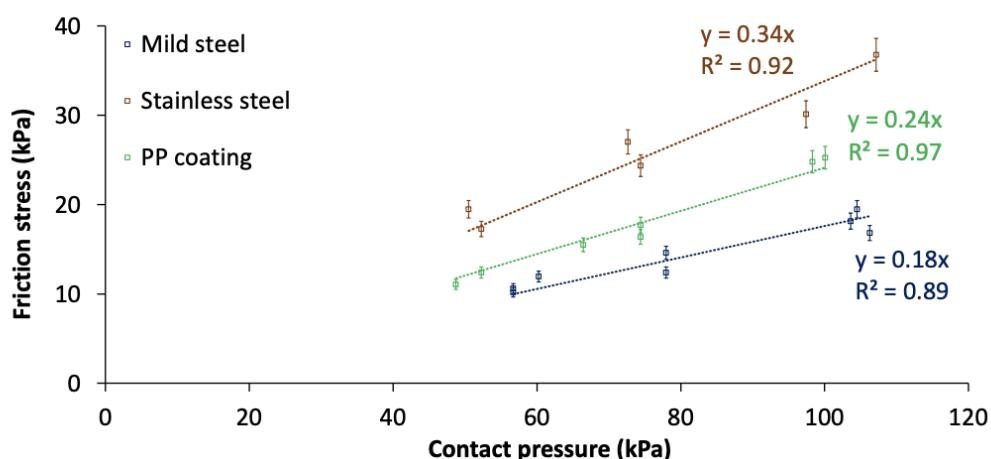
FIGURE 2.50 – Contraintes de frottement dynamique du béton standard en fonction des surfaces de coffrage étudiés [54]
