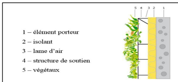
FIGURE 2.5 – Schéma de principe d'un mur simple
