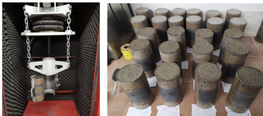
FIGURE 2.78 – Dispositif de vibrocompactage (gauche) - Eprouvettes réalisées (droite)
