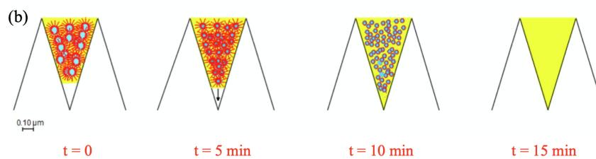
FIGURE 2.40 – Evolution schématique des émulsions inverses dans l'état de Wenzel [79]
