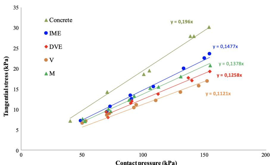
FIGURE 2.49 – Contraintes de frottement dynamique en fonction de la pression de contact pour les agents de démoulage étudiés ( $v = 0.84 \text{ mm/s}$ ) [79]
