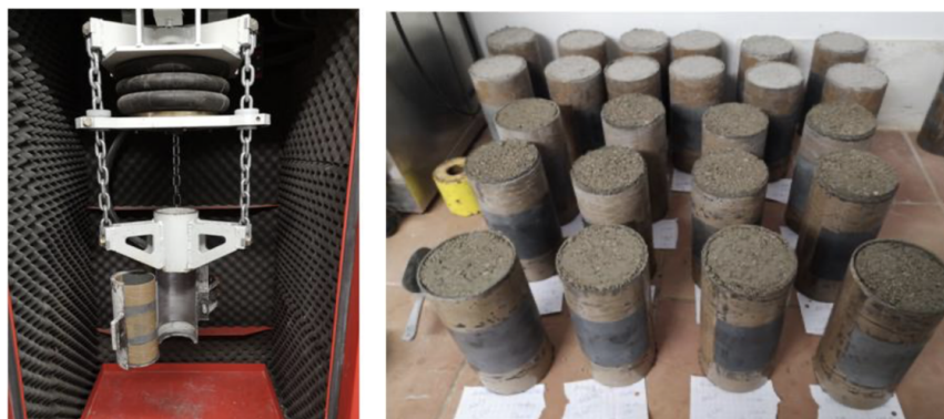
FIGURE 2.78 – Dispositif de vibrocompactage (gauche) - Eprouvettes réalisées (droite)
