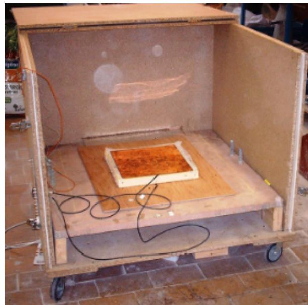
FIGURE 2.7 – Box des mesures de conductivités thermiques
