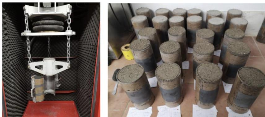
FIGURE 2.78 – Dispositif de vibrocompactage (gauche) - Eprouvettes réalisées (droite)
