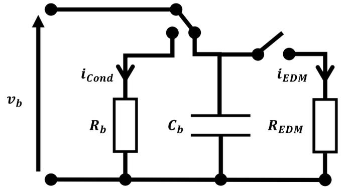
Fig. 3. Circuit équivalent d'un roulement à bille.
