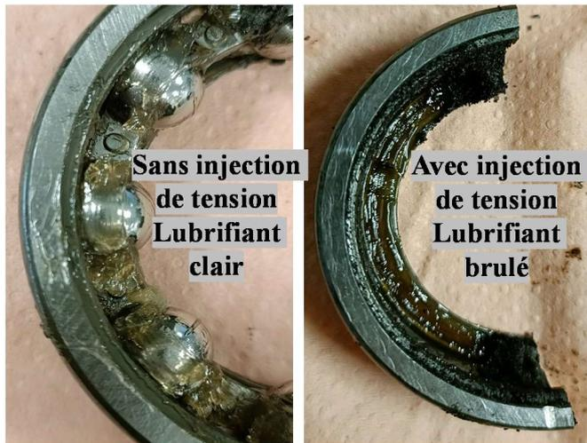
Fig. 9. Etat du lubrifiant : roulement sans décharges (gauche) vs vieilli avec décharges (droite).
