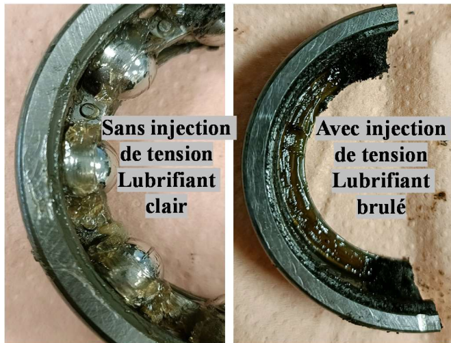
Fig. 9. Etat du lubrifiant : roulement sans décharges (gauche) vs vieilli avec décharges (droite).
