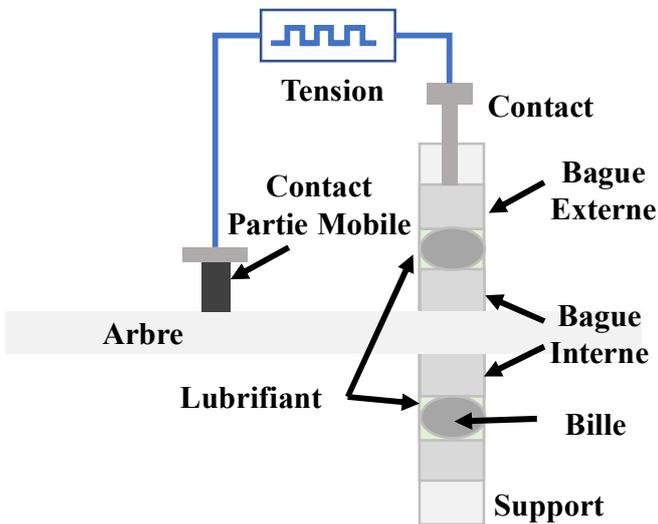
Fig. 6. Illustration du montage mécanique de banc d'essai pour vieillissement de roulements par électroérosion.
