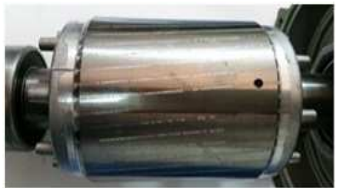
Figure 1. Rotor de la machine asynchrone avec une barre cassée
