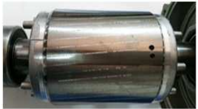
Figure 2. Rotor de la machine asynchrone avec deux barre cassée adjacentes
