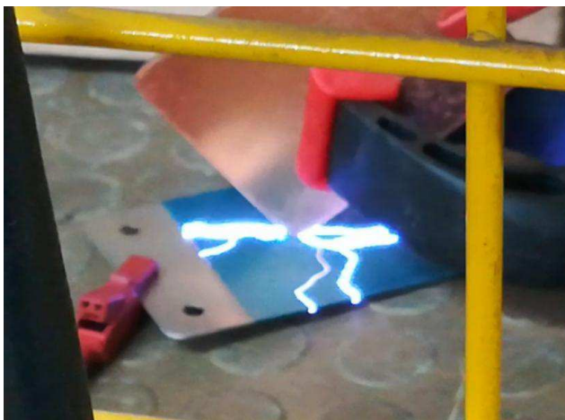
Fig. 15. Ajout d'une couche de vernis additionnelle au niveau des arêtes.
