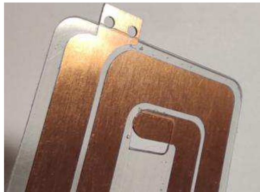
Fig. 18. Dépôt d'isolant par fabrication additive.
