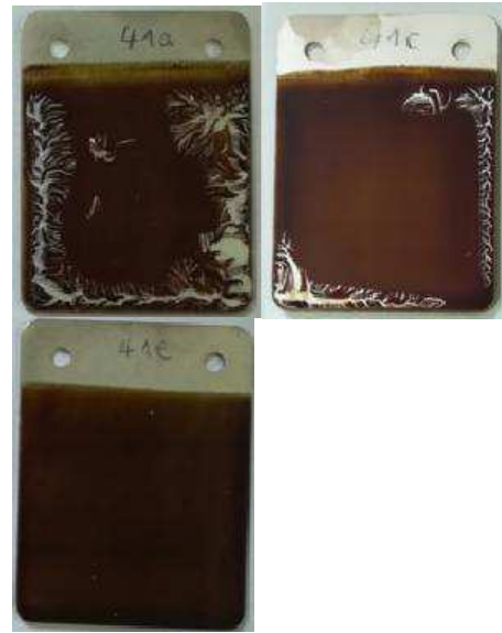
Fig. 6. Comparaison de la tenue thermique avec différents pourcentages de promoteur d'adhésion (0,5,1 et 2 %) – Vieillissement à 200°C / 8h.
