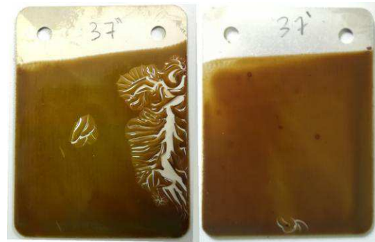
Fig. 8. Vieillessement 2h à 200^{\circ}\text{C} avec promoteur d'adhésion A (gauche) et sans promoteur d'adhésion (droite)
